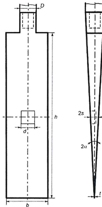
$h$  — расчетная длина рабочей грани;  $b$  — ширина рабочей грани;  $t$  — толщина режущей кромки;  $2\alpha$  — угол раскрытия клина;  $d$  — ширина (диаметр) датчика давления;  $D$  — диаметр штанги;  $2s$  — толщина клина по центру датчика давления; разное перемещение грунта, задаваемому рабочими гранями расклинивающего дилатометра
