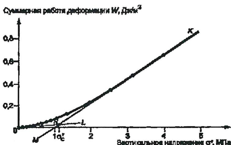
К — кривая зависимости суммарной работы на единицу объема от напряжения. 1 — касательная линия к начальному линейному участку кривой  $K$ . М — касательная ко второму линейному участку кривой  $K$ . Н — точка пересечения касательных линий  $L$  и  $M$ , соответствующая давлению предуплотнения
