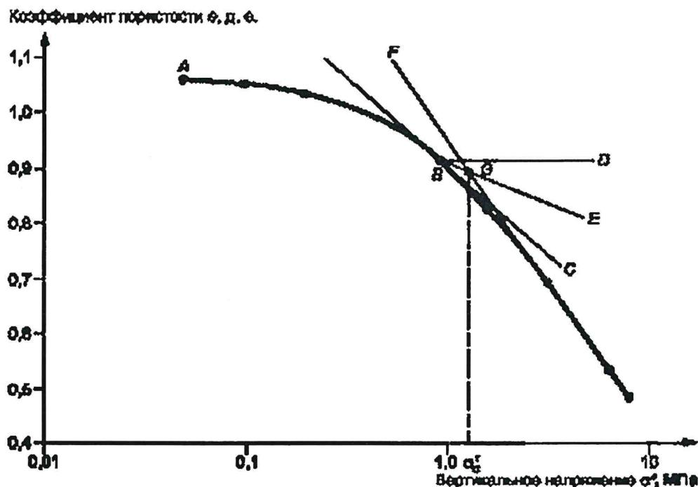
Л — кривая зависимости коэффициента пористости от вертикального напряжения, В — точка перелома (максимальной кривизны\*) кривой. С — касательная линия к точке В: Д — горизонтальная линия к точке В: Е — биссектриса угла между линиями С и О: Я — касательная линия к линейному участку кривой, соответствующей главной компрессионной ветви: Г — точка пересечения линий Е и F, соответствующая давлению предуплотнения
