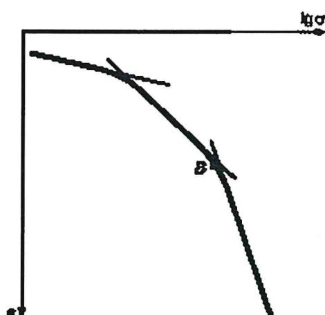
Рисунок Г.2 — Определение точки В при двух точках перелома графика
