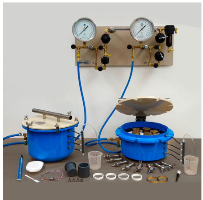
Рис. 7. Устройство с прижимной пластиной: вид прибора в лаборатории
