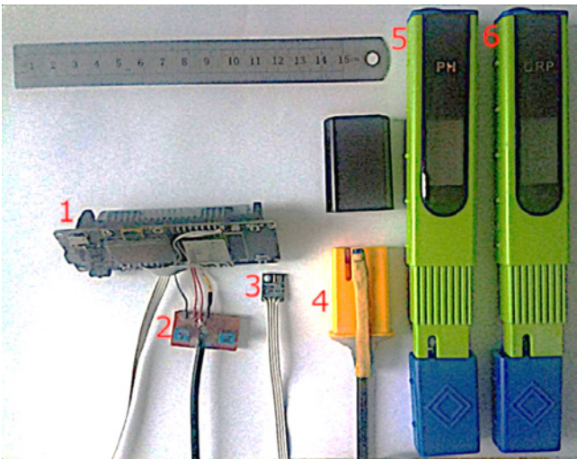
Рис. 2. Общий вид оборудования для измерения суспензионных эффектов \Delta pH и \Delta Eh (объяснения в тексте)
