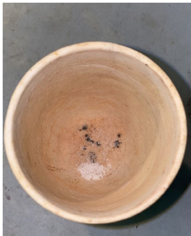
Рис. 3. Характерные этапы определения «аморфных» соединений кремния в исследуемом песчаном грунте по методу К. К. Гедройца: а) выпаренный гель кремниевой кислоты после удаления органических веществ; б) «аморфные» соединения кремния после прокаливания фильтра в муфельной печи.
