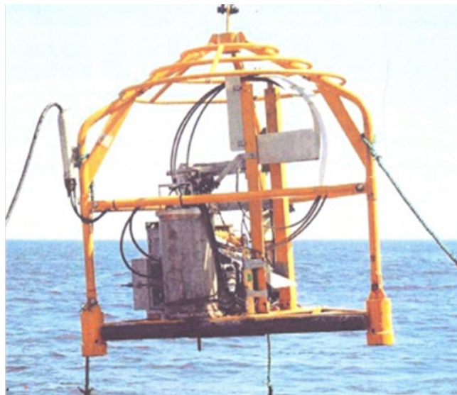
Рис. 2. Установка статического зондирования «Sea Scout»
