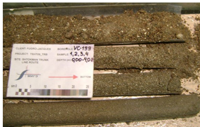
Рис. 5. Характерный вид песчаных грунтов на участке берегового примыкания трубопровода
