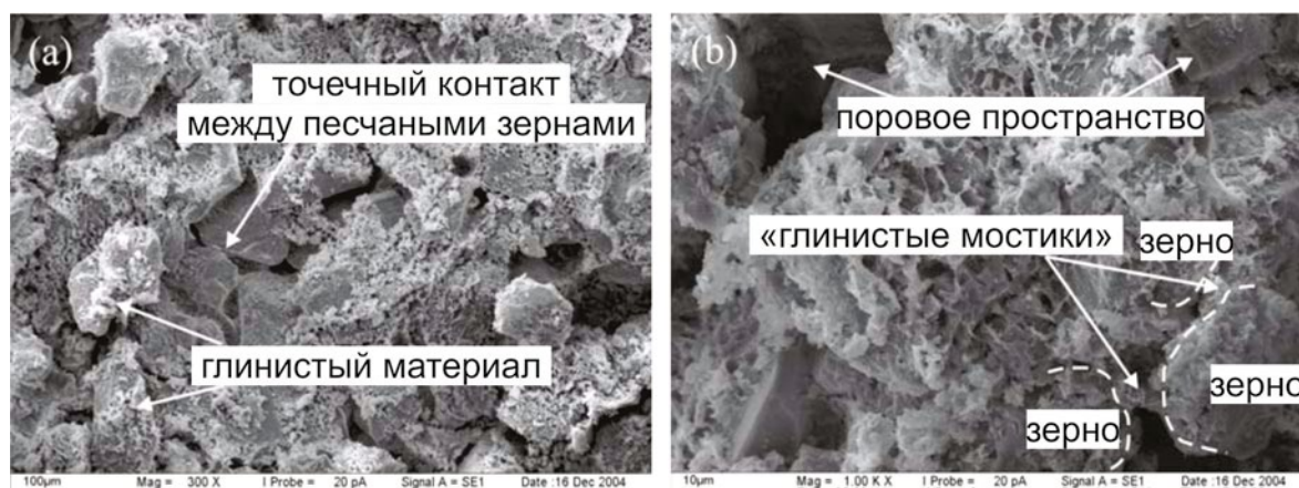
Рис. 8. Зернистая (скелетная) микроструктура модельного песчаного образца с добавлением бентонита: (а) — увеличение \times 300 , (б) — увеличение \times 1000 [27]
