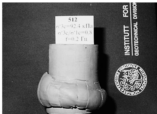
Рис. 7. Фото образца глины из толщи «Tiller» после разжижения в динамическом трехосном испытании [1]
