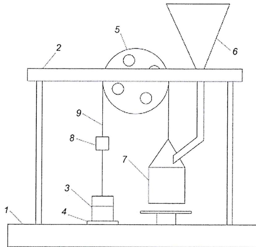
1 — основание; 2 — стойка; 3 — форма для грунта; 4 — попозья для формы; 5 — блок; 6 — воронка; 7 — ведерко для груза; 8 — штамп с противовесом для уравновешивания формы для грунта и ведерка и площадкой для груза; 9 — струна
