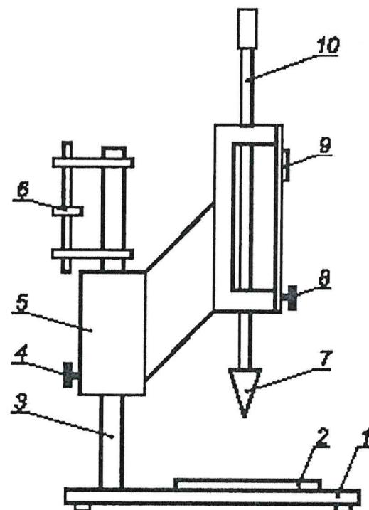
1 — основание; 2 — рабочий столик; 3 — стойка; 4 — фиксирующий винт; 5 — подвижный корпус; 6 — установочный винт;
