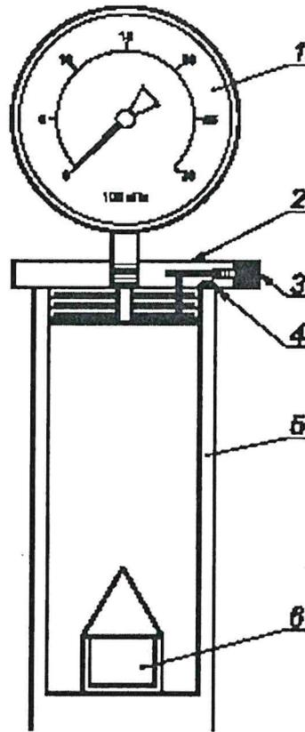
1 — манометр; 2 — крышка реакционного цилиндра; 3 — предохранительный клапан; 4 — уплотнительные кольца;
